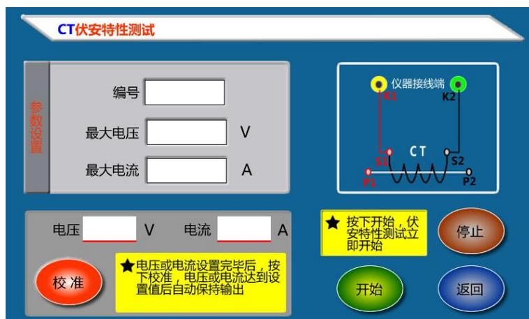
图 4，CT 励磁特性测试界面
